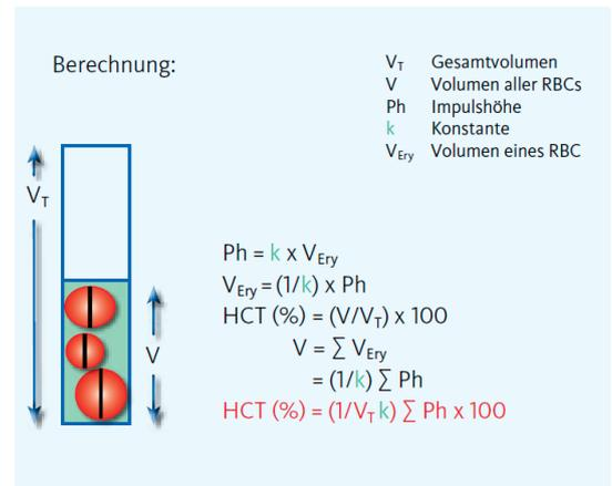
**Abb. 3** Formel für die automatische HKT-Bestimmung
